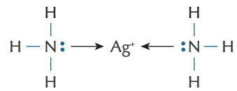
Figur 23. Ammoniaks kompleksbinding til sølvion.
